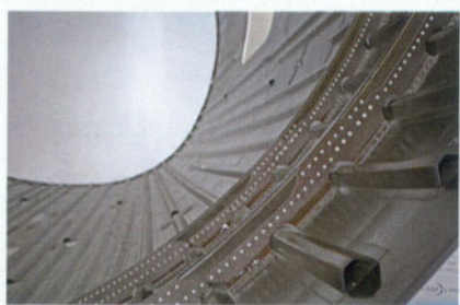
图3 波音787的复合材料加筋结构
