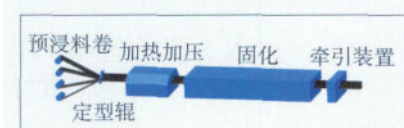
图2 预浸料拉挤成形原理示意图
